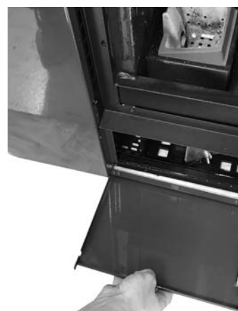
Fig. 46 - Odstranjanje sprednjih plošč
