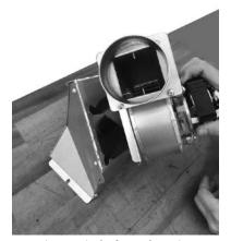
Fig. 27 - Fix the fan to the casing
