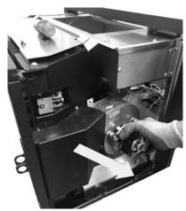
Fig. 52 - Remove the fan
