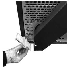
Fig. 56 - Fume conduit cleaning
